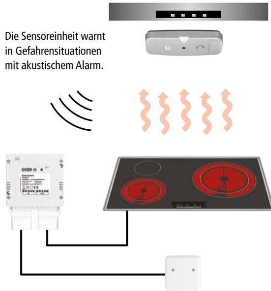
Die Steuereinheit wird hinter dem Herd zwischen Herdanschlussdose und Kochfeld installiert und schaltet den Herd automatisch ab.
